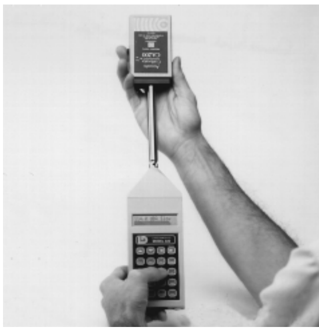
Figura 47.2 • Sonómetro: control de calibración. Cortesía de Larson Davis.
