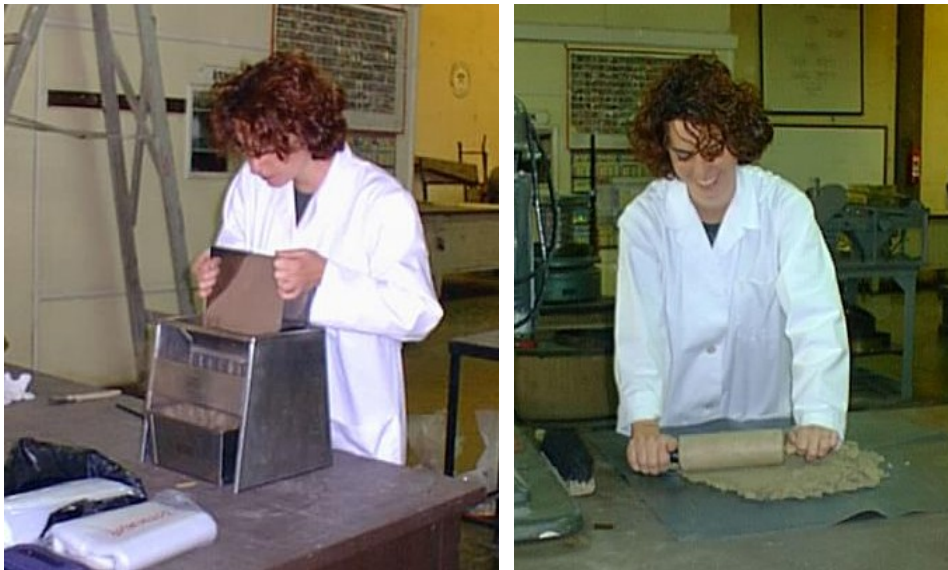
Fotos 5a (izquierda) y 5b (derecha). En la 5a se muestra un cuarteador de ..., mientras que en la 5b podemos observar el proceso de desapelmazado de una muestra mediante rodillo de amasar.
