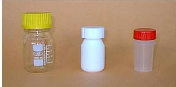
Foto 3.- Botes de distintos tipos utilizados para la toma de muestras de agua. El de la izquierda es de vidrio, el del centro de teflón, y el de la derecha de plástico, de tipo sanitario.
