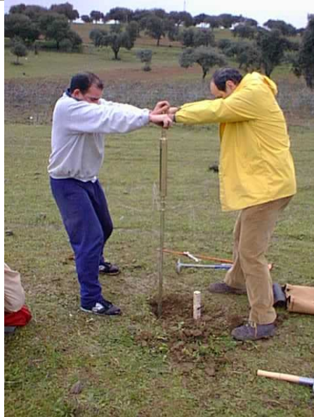
Fotos 2a (izquierda) y 2b (derecha). En la 2a puede observarse una muestra tomada con medios “artesanales”: azada, pico, etc., mientras que la 2b muestra un muestreo mediante tomamuestras helicoidal.
