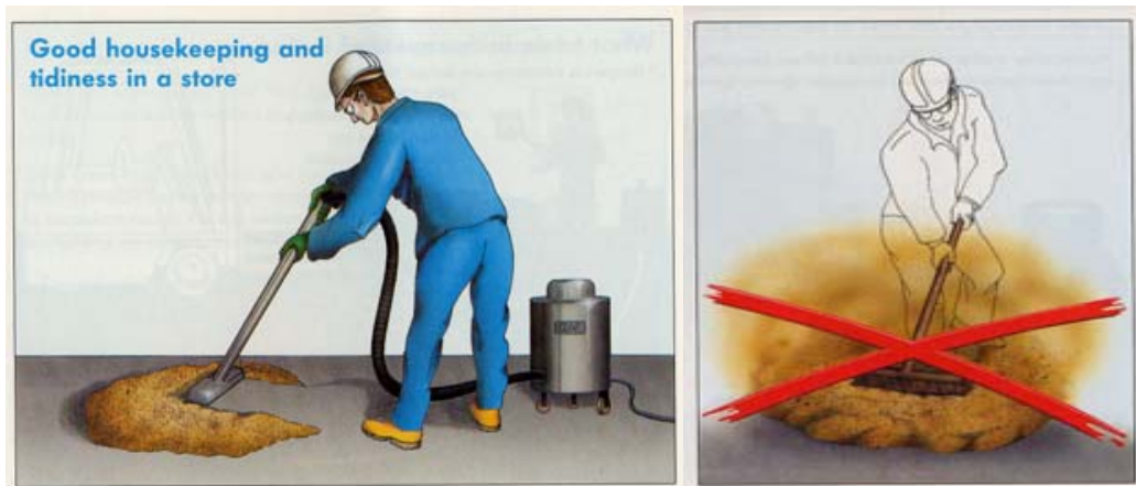
Figura 3.2: Eliminación de depósitos de polvo 4
