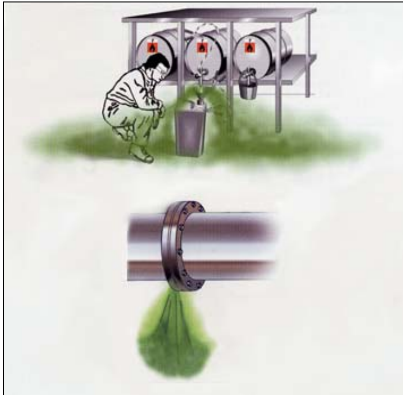
Figura 1: Ejemplos de formación de atmósfera explosiva 4
