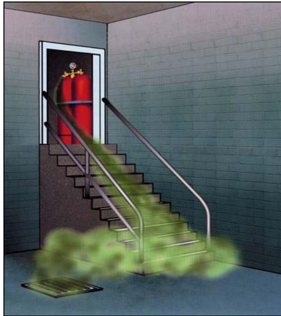
Figura 2.3: Modo de propagación de los gases licuados (ejemplo) 4
