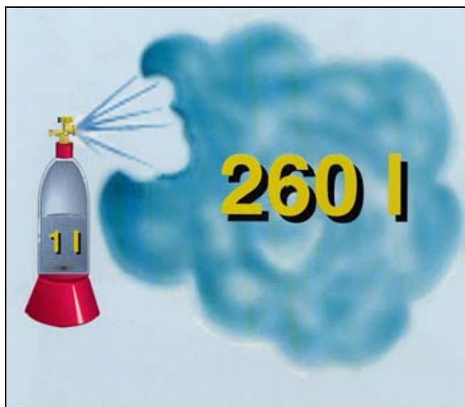
Figura 2.4: Una cantidad incluso pequeña de líquido inflamable ya puede, al evaporarse, provocar grandes cantidades de vapores inflamables (ejemplo: propano licuado). Nota: 1 litro de propano líquido, al transformarse en gas y diluirse en aire al límite inferior de explosividad daría lugar a 13.000 litros de atmósfera explosiva. 4
