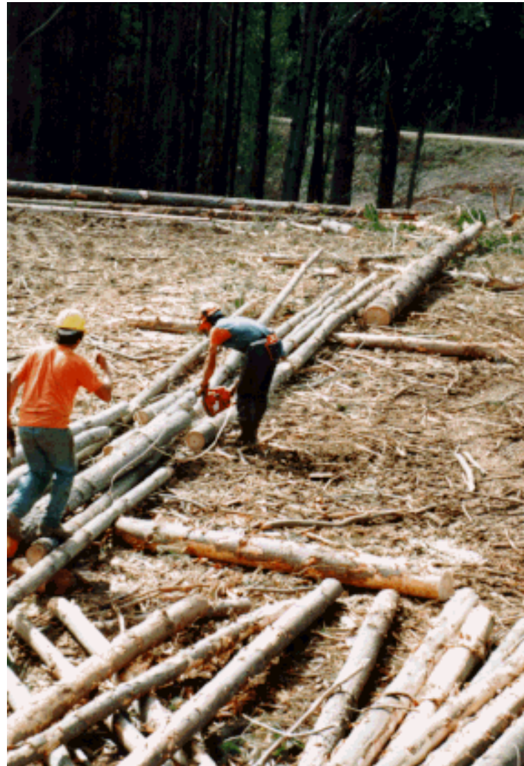
Figura 10.30. Postura de trabajo adoptada por un motosierrista durante el trozado
