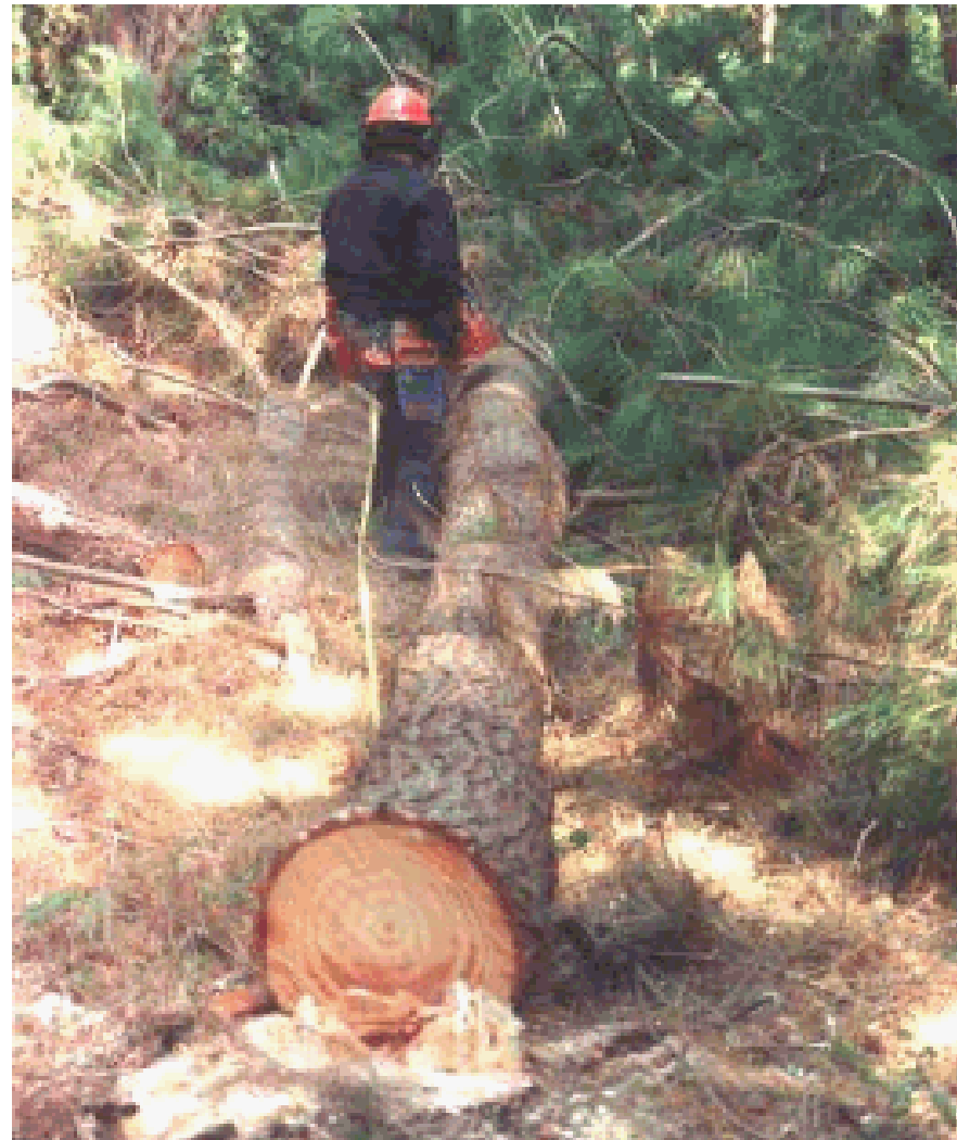
Figura 10.43. Motosierrista desramando en el lado izquierdo del fuste y en dirección a la copa del árbol
