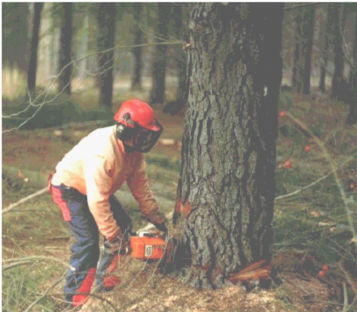
Figura 10.32. Motosierrista iniciando el corte de caída
