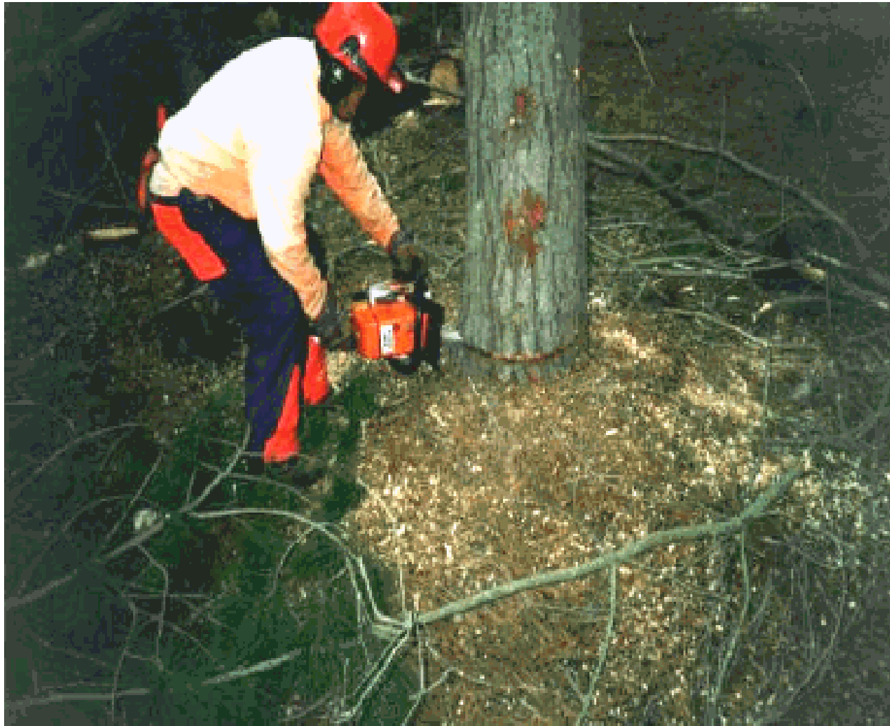
Figura 10.33. Motosierrista finalizando el corte de caída, cuando la espada es mayor al diámetro del árbol
